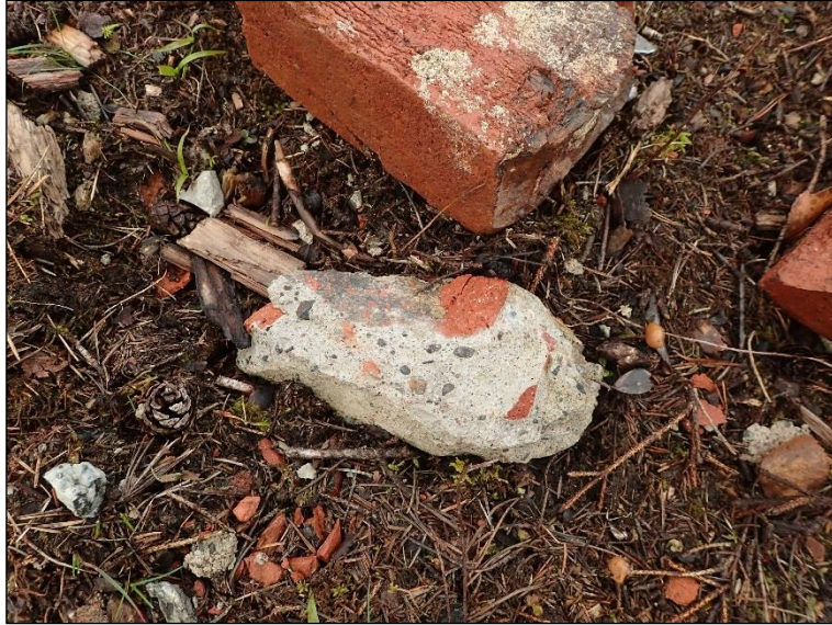
Tiili ja hienosekotteisen betonin kappale.
